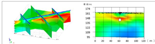
土木分野では、トンネル工事、地すべり調査、地下水調査、地盤変状調査、埋め立て地盤および汚染調査など、広範囲で活用可能。火山、温泉、地熱調査などのための深さ3000m程度の地下深部調査も可能である
