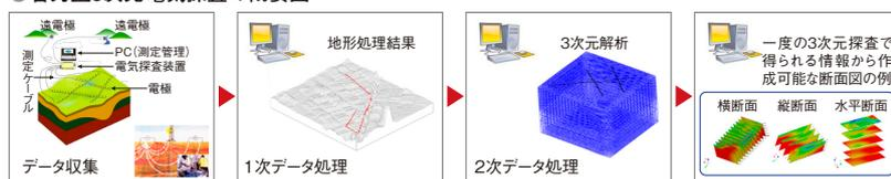
測定作業によりデータ収集を行い、1次データ処理として、数値地形図に電極位置などを入力。2次データ処理として3次元解析を行った後、その結果を図として表現する
